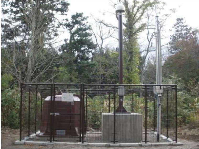
写真1 恐山火山山頂部（湯坂）に設置した地震及び地殻変動の観測施設
